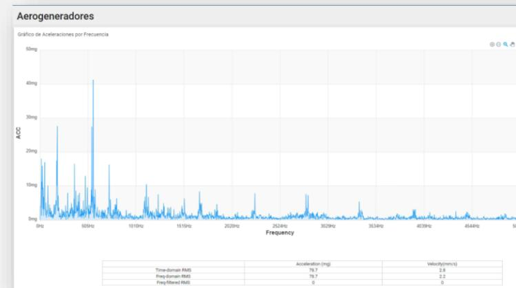
Análisis espectral de vibraciones mediante acelerómetro
